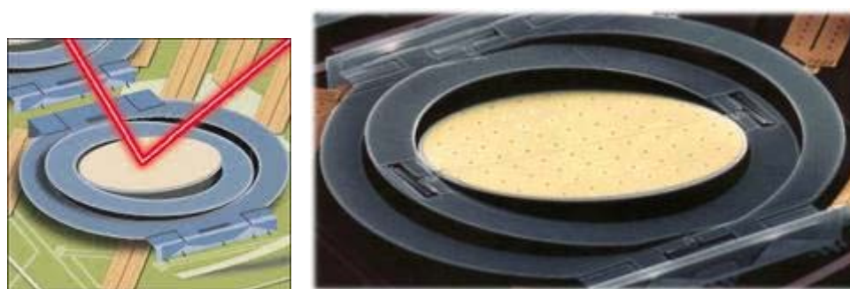
Obr. 5. Modul optického spínače využívajícího matici MEMS
